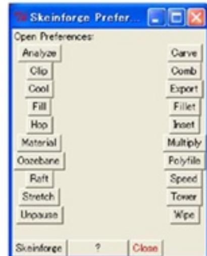
**3c.** 実際にSTLを変換するには、ダイアログ左下のSkeinforgeボタンをクリックします。するとSTLを入力するファイルダイアログが表示されますので、Blenderで作ったSTLファイルを指定して下さい。その後、長時間だんまり状態になるので終わるまで放置します。
